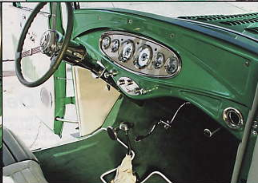
Im Interieur finden wir ein SoCal-Cockpit mit klassischer Instrumentierung vor; auf der Flaming-River-Lenksäule sitzt ein typisches Banjo-Lenkrad
