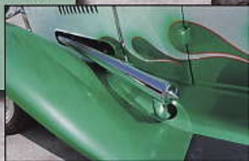
Wheeler's Speedshop fertigte eigens für diesen Wagen die Auspuffanlage mit Krümmern und Magnaflow-Schalldämpfern an
